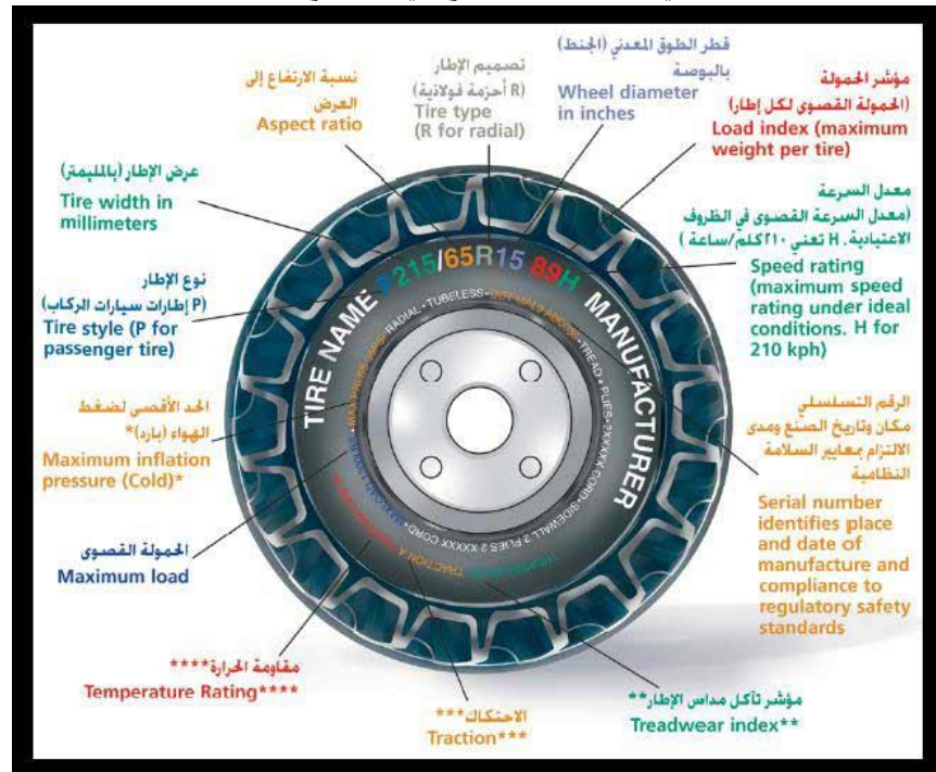
شكل رقم ( ٨ ) يوضح كيفية قراءة البيانات المدونة على الإطار
