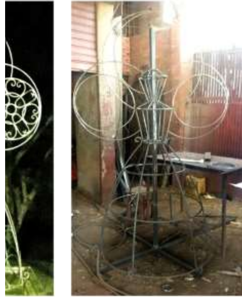
شكل (١٦) لمراحل التنفيذ للبناء الشكلى لهيئة عروسة المولد التشكيل بالحديد/إضافة الحلول الزخرفية الخطية ثم التشطيب بالدهانات العازلة
