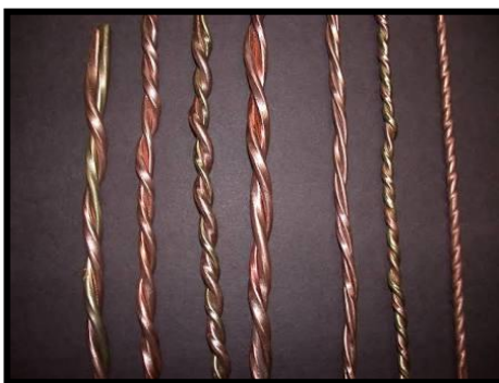
شكل رقم (٨) يوضح أسلوب التشكيل بالبرم للأسلاك المعدنية.
